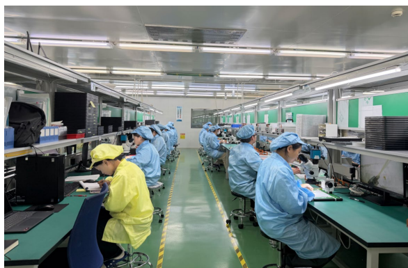
精工訊捷光電ではクリーンルーム内でMTファイバアレイを量産
